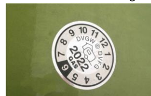
Etykieta kontrolna zbiornika gazu
